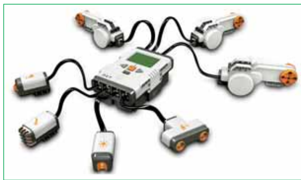
Figure 2 : La brique NXT possède 4 ports d'entrée, 3 ports de sortie, un écran LCD 100 x 64 et un haut-parleur
